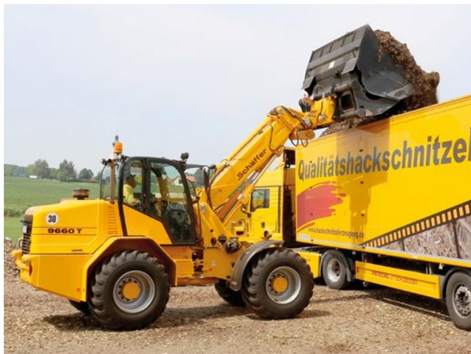
Nur knapp 20 Minuten dauert das Beladen des 94 Schüttraummeter fassenden Schubbodensattelzuges mit dem 9660 T und der Großraum-Hochkippschaufel. Die Hubhöhe mit eingefahretem Teleskoparm beträgt beachtliche 4,80 m.
