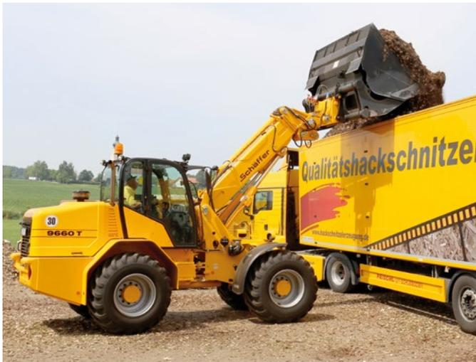
Nur knapp 20 Minuten dauert das Beladen des 94 Schüttraummeter fassenden Schubbodensattelzuges mit dem 9660 T und der Großraum-Hochkippschaufel. Die Hubhöhe mit eingefahretem Teleskoparm beträgt beachtliche 4,80 m.
