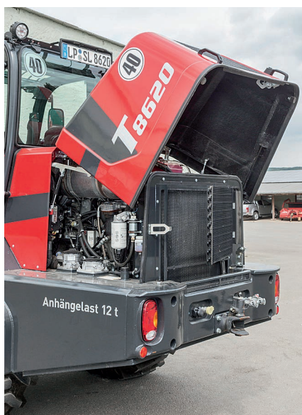
Der 3,6-l-Deutz-Vierzylinder erfüllt die Abgasstufe IV und ist mit drei Motorleistungen von 75 kW/102 PS bis 100 kW/136 PS verfügbar.
