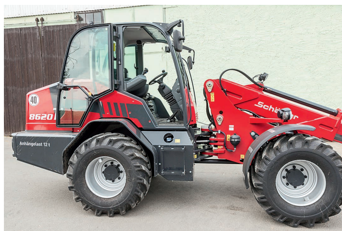
Wegen der AdBlue-Anlage mit 20-l-Tank ist rechts nur noch ein provisorischer Aufstieg.
