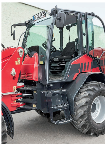
Der linke Aufstieg ist steil, aber geräumig. Das Knickgelenk ist stabiler geworden und hat zwei Lenkzylinder.
