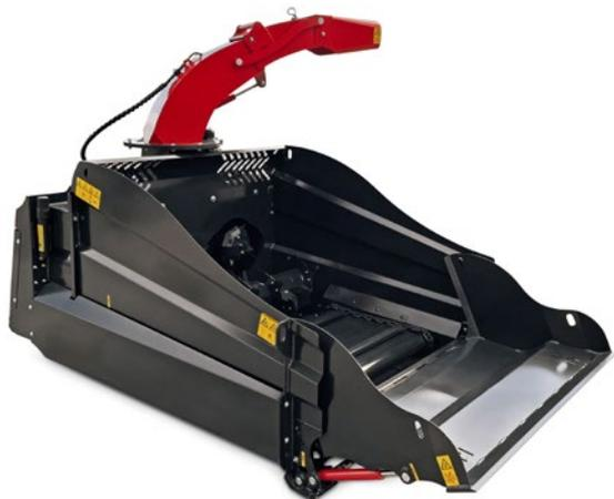
Diese Einstreumaschine verteilt Quader- und Rundballen in den Stallungen. Die Strohballen werden bequem über die Ladeklappe aufgenommen und über den hydraulisch angetriebenen Kratzboden zur Auflösewalze befördert. Von hier aus gelangt das Stroh zum Wurfgebläse mit einer Wurfweite von bis zu 12 Metern. Optional ist eine Wassersprüheinrichtung erhältlich.
