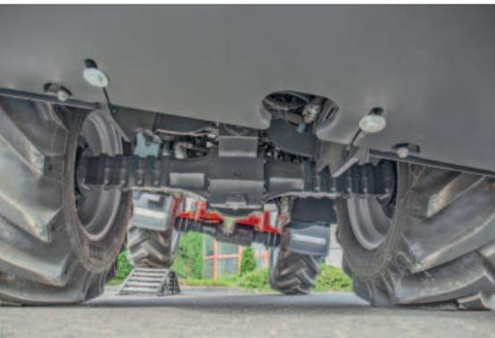
Dank der hinteren Pendelachse ist der Lader sehr kippstabil.
