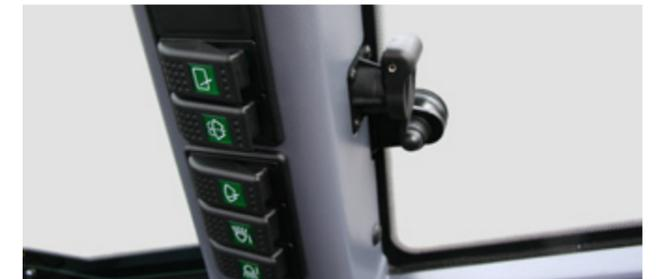
Zusammengefasste Schalterleiste, Steckdose mit Dauerstrom
