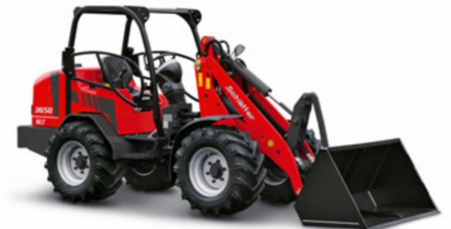
Mit einer Bauhöhe ab 2,04 m ist der 3650 SLT besonders kompakt gebaut.
