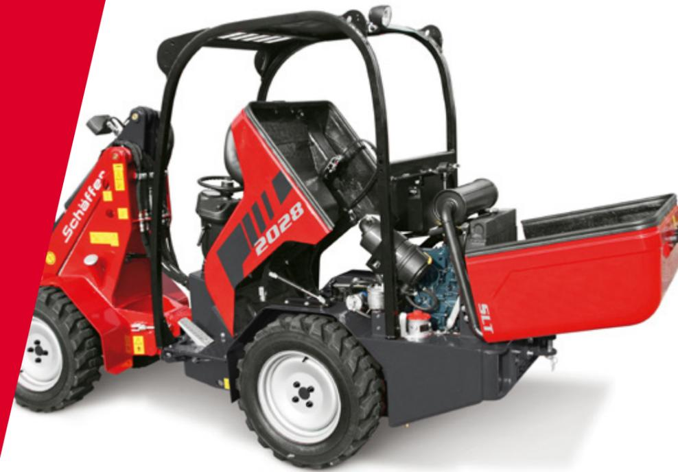
Die vordere und hintere Motorhaube des 2028 SLT lassen sich einfach öffnen. Wartungsarbeiten werden durch den leichten Zugang enorm erleichtert.
