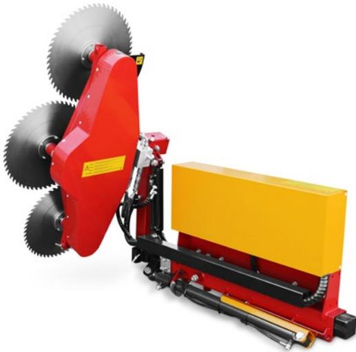
Mit der hydraulischen Astsäge erfolgt ein effizienter Rückschnitt von dichten Hecken oder Bäumen. Drei große Sägeblätter mit einem Durchmesser von jeweils 60 cm schneiden Äste mit einer Stärke von bis zu 15 cm. Der stabile Anbauahmen ermöglicht eine hydraulische Seitenverschiebung und eine stufenlose Seitenverschwenkung.
