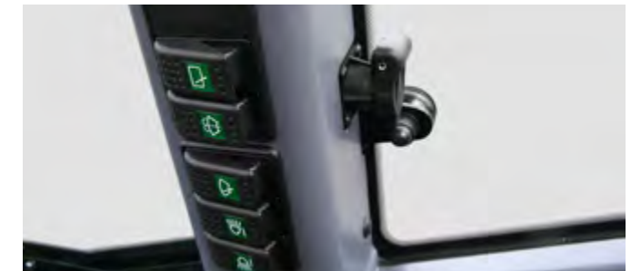
Zusammengefasste Schalterleiste, Steckdose mit Dauerstrom
