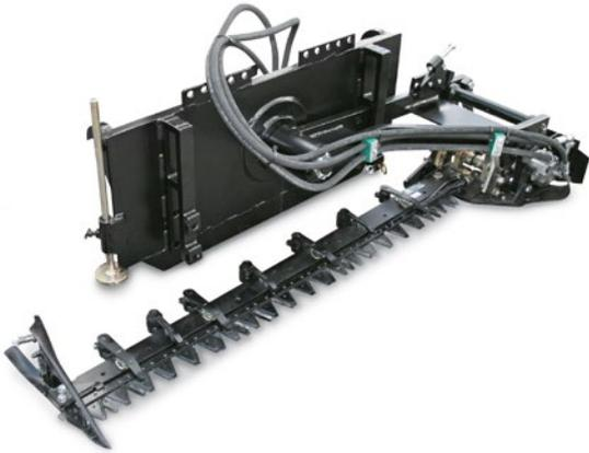
Das hydraulisch angetriebene Doppelmessermähwerk überzeugt durch ein perfektes Schnittbild bei einer gleichzeitig hohen Flächenleistung. Es trennt Grashalme oder Blätter sauber ab und bietet dadurch auch den Kleinlebewesen ausreichend Fluchtmöglichkeiten. Deshalb kann es für den bodenschonenden Einsatz und im Ökolandbau ebenfalls bestens verwendet werden. Die Neigung des Balkens ist stufenlos einstellbar. Somit lässt sich das Mähwerk auch an Böschungen und jungen Hecken einsetzen.
