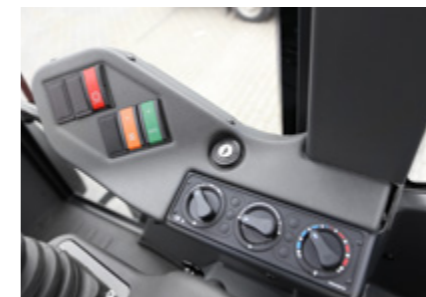
Clé de contact et manettes de commande de chauffage ou de climatisation (option) sous la main.
