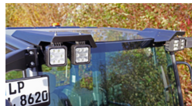
Jusqu'à quatre phares de travail peuvent être montés à l'avant de la cabine.
