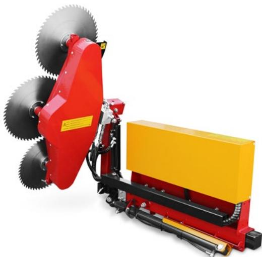
La scie d'élagage hydraulique permet de couper efficacement les haies et arbres denses. Trois grandes lames d'un diamètre de 60 cm chacune coupent des branches d'une épaisseur allant jusqu'à 15 cm. Le cadre de montage robuste permet un déplacement latéral hydraulique et un pivotement latéral en continu.
