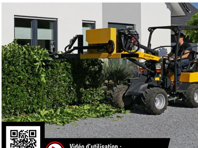
Avec cet élagueur, la taille des haies et des arbres est effectuée rapidement et soigneusement. L'élagueur peut couper des branches d'une épaisseur allant jusqu'à 5 cm. Grâce au dispositif d'inclinaison hydraulique, l'élagueur se règle en continu et effectue des coupes verticales, horizontales ou obliques. De plus, le cadre de montage dispose d'un déplacement latéral mécanique.
