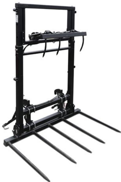
Cette fourche à balles permet de ramasser, déplacer et empiler au mieux les balles de foin et de paille. Elle est équipée de pinces à rabattement mécanique pour conduire sûrement sur la route et dispose d'un cadre d'appui d'une hauteur totale de 1,75 m dans la version standard. Sont disponibles en option des dents à rabattement hydraulique, un preneur supérieur et des rehausses supplémentaires.
