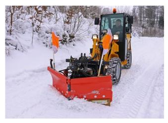
Das Vario-Schneeschild ist mit zwei hydraulisch schwenkbaren Klappflügeln ausgestattet. Schneeräumen ist in V-, Y- oder Diagonalstellung möglich. Dieser Schneepflug ist damit der ideale Begleiter für die Schneeräumung von Geh- oder Fahrradwegen und Straßen.
