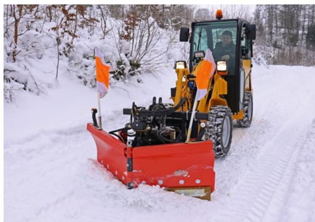
La lame à neige Vario est équipée de deux volets pivotants hydrauliques. Elle permet donc de déneiger en position V, Y ou en diagonale. Ce chasse-neige est donc le compagnon idéal pour déneiger les chemins piétons, les pistes cyclables et les routes.
