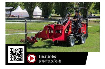
Der Zaunmäher befreit eingewachsene Zaunpfosten oder Leitplanken effektiv und schnell von Halmbewuchs. Der Mähteller wird dazu seitlich vom Lader unter den Zaun geführt. Er kann sich um die Mittelachse drehen, sobald er den Pfosten berührt und schneidet ihn somit vollständig frei. Die Kunststoffgleitschienen schützen die Pfosten vor Anfahrtsbeschädigungen.
