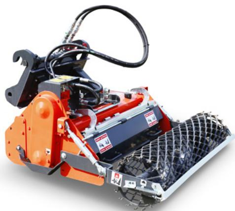
Die hydraulische Bodenumkehrfräse ist der zuverlässige Partner für die Saatbettvorbereitung im Garten-Landschaftsbau. Die gegen die Fahrtrichtung drehenden Fräsmesser nehmen den Boden auf und werfen ihn gegen ein Siebgitter. Hierbei werden grobe Bestandteile ausgesiebt und vergraben. Die von Gräsern und Pflanzenresten befreite Erde liegt als Deckschicht obenauf. Dank der Krümelwalze wird der Boden rückverfestigt.
