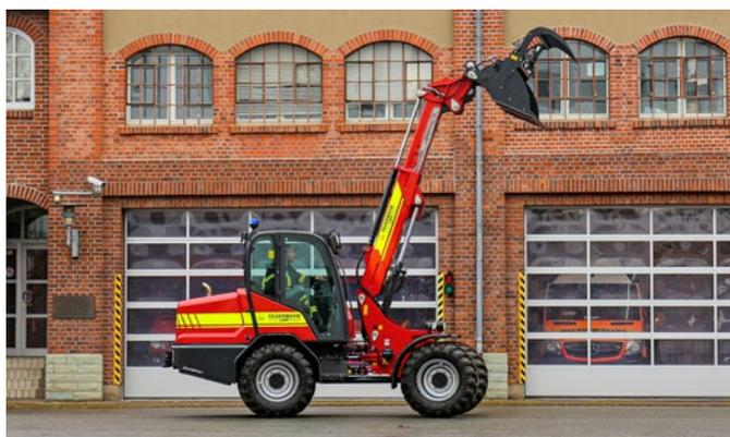
Der Schaeffer 6680 T ist ein Teleradlader mit einem Einsatzgewicht von rund sechs Tonnen und einer Hubhöhe von 4,95 m.
