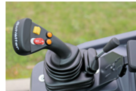
Joystick mit erweitertem Funktionsumfang
