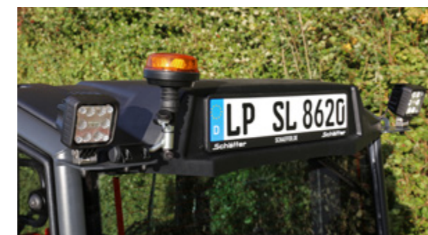
A l'arrière, il est possible d'installer jusqu'à quatre phares de travail ou de remplacer un phare par un gyrophare.
