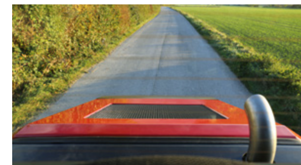
Le capot moteur incliné vers l'arrière offre une meilleure vue sur la zone de travail derrière la machine.
