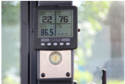
Affichage d'informations dans le montant B pour le système d'échappement (pour les chargeuses des séries 86 et 96)
