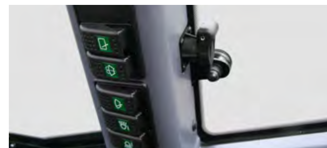
Zusammengefasste Schalterleiste, Steckdose mit Dauerstrom
