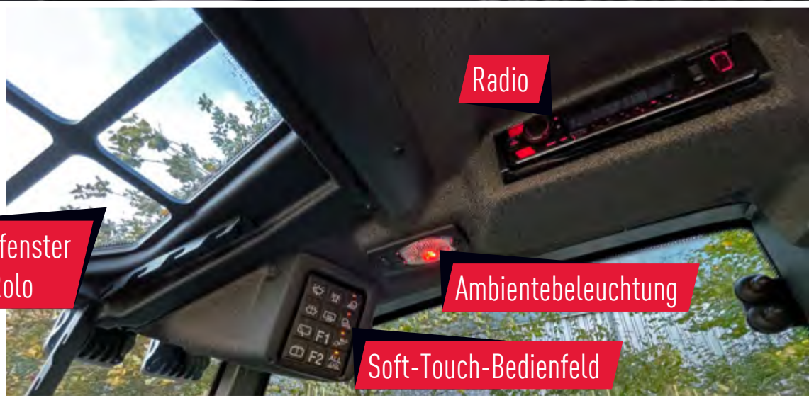
Blick nach oben: Neben dem großzügig dimensionierten Dachfenster befindet sich das Soft-Touch-Bedienfeld mit Schnellzugriff auf die wichtigsten Funktionen, die Ambientebeleuchtung und das Radio.
