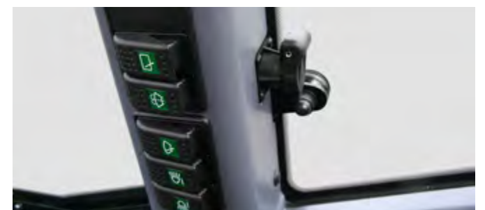
Zusammengefasste Schalterleiste, Steckdose mit Dauerstrom
