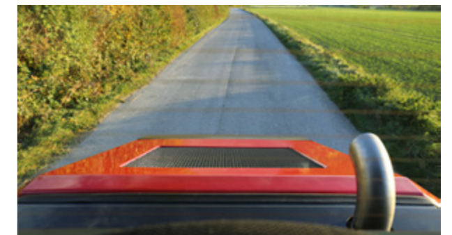
Die nach hinten schräg abfallende Motorhaube ermöglicht einen besseren Blick auf den Arbeitsbereich hinter der Maschine.
