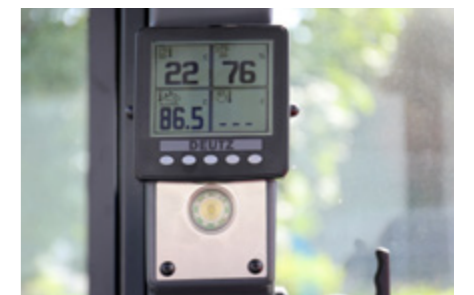
Info-Display in der B-Säule für das Abgassystem (bei Ladern der 86er- und 96er-Serie)
