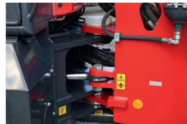
Das extrem stark dimensionierte Knickgelenk ist unverwundlich und wartungsfrei. Hohe Einschlagwinkel bringen Wendigkeit.
