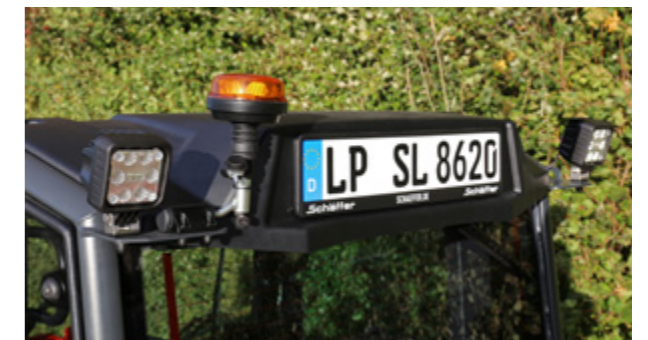
Nach hinten finden ebenfalls bis zu vier Arbeitsscheinwerfer Platz, alternativ kann ein Scheinwerfer durch eine Rundumleuchte ersetzt werden.
