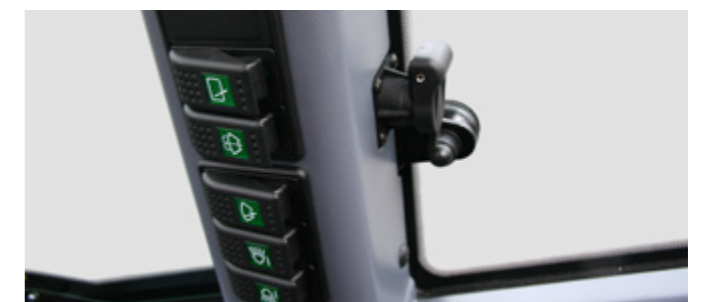
Zusammengefasste Schalterleiste, Steckdose mit Dauerstrom
