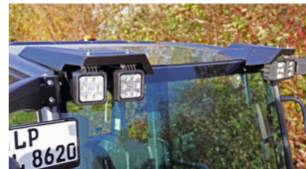
Bis zu vier Arbeitsscheinwerfer können in Frontrichtung an der Kabine angebracht werden.
