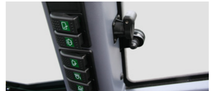
Zusammengefasste Schalterleiste, Steckdose mit Dauerstrom
